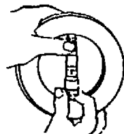
Fig. 11 - Medição de um diâmetro com o micrômetro tubular.
