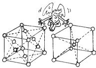
Neste modelo de sólido cristalino as moléculas não ficam paradas, e sim oscilam. Essa oscilação é mais ou menos intensa, dependendo da temperatura do material.
