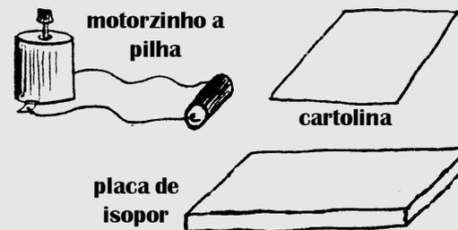
Usando a cartolina faça uma pá e acople ao motor. Faça uma abertura no isopor para o movimento da pá e posicione o motorzinho conforme ilustra a figura.
