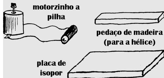
Com um canivete, "esculpa" uma hélice em um pedaço de madeira e acople-a ao motor. Monte um barquinho como na figura e coloque-o na água.
