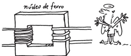
Sendo  $U_p$  e  $U_s$  as tensões nos terminais dos fios nos enrolamentos primário e secundário e  $N_p$  e  $N_s$  o número de voltas de fio em cada um desses enrolamentos, vale a seguinte relação para o transformador:
