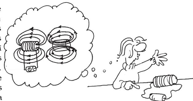
**A diferença em relação ao ímã é que no fio o campo magnético deixa de existir quando a corrente elétrica cessa.**
