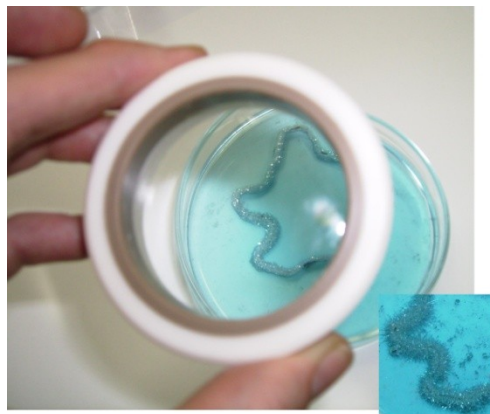
Figura 1: depósito de prata ao redor do fio de cobre, em solução.
