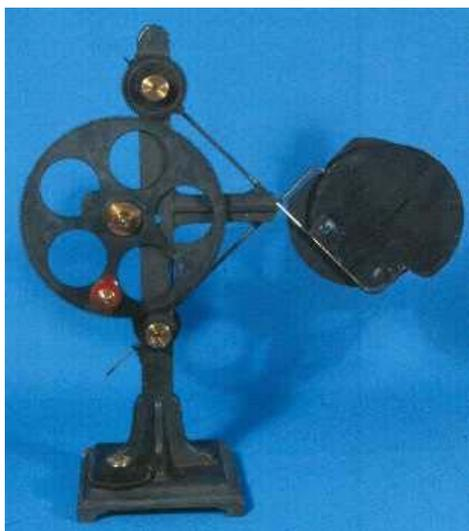
FIGURA 2. Aparato de Stöhrer's da Max Kohl. O instrumento consiste de um sistema formado por dois discos com fendas perpendiculares em seus centros. Quando a manivela é acionada, os dois discos movem-se perpendicularmente em M.H.S. (Fonte: <http://www.kenyon.edu/physics.xml>. acessado em 08/05/2009)
