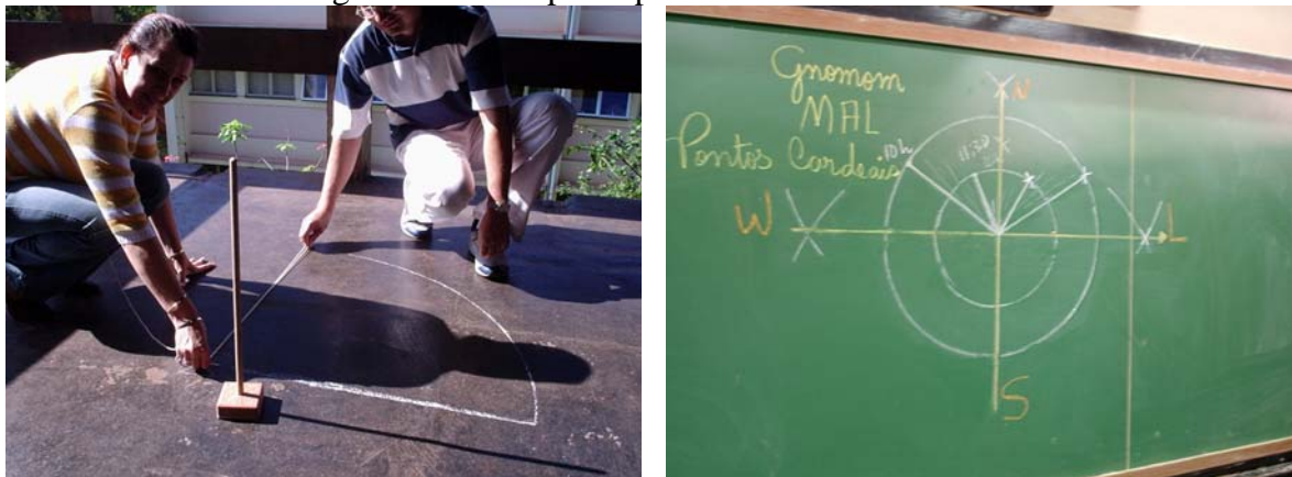
Determinação dos Pontos Cardeais com o Gnomon
