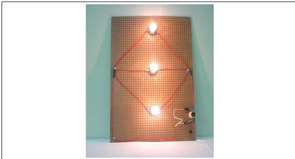
FIGURA 3. FOTOGRAFIA DE LÂMPADAS ASSOCIADAS EM PARALELO.
