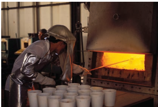
Forno para análise de ouro em Belo Horizonte, MG
