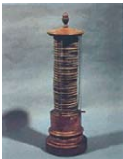
■ Fig. 1: Modelo da Pilha de Volta. A pilha inventada pelo físico italiano possibilitou um meio para produzir corrente elétrica para fins práticos. (Deutsche Museum – Munique). Fonte: www.copel.com/pagcopel.nsf/
