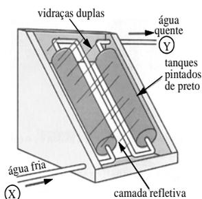
O uso mais popular de energia solar está associado ao fornecimento de água quente para fins domésticos. Na figura ao lado, é ilustrado um aquecedor de água constituído de dois tanques pretos dentro de uma caixa termicamente isolada e com cobertura de vidro, os quais absorvem energia solar.
