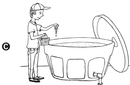
Adicionar cloro em uma caixa-d'água e mantê-la fechada.
