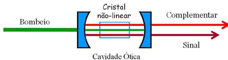
Figura 3.1: Esquema do Oscilador Paramétrico Ótico. O feixe de bombeio é convertido em dois outros feixes, sinal e complementar, via conversão paramétrica
