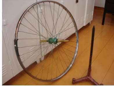
Figura 21: Roda de bicicleta usada como giroscópio.
