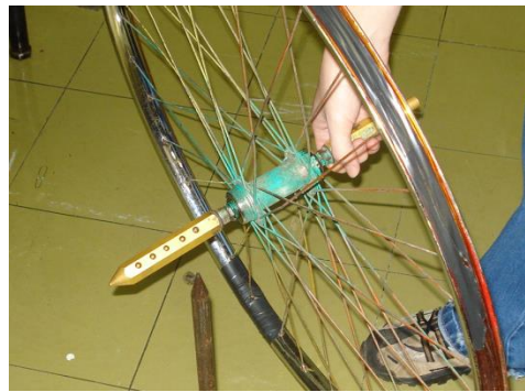
Figura 22: Fotografia do eixo da roda, onde podem-se observar os furos nos quais é apoiado o giroscópio.
