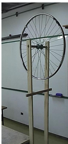
Figura 26: Fotografia da roda apoiada para a determinação do seu momento de inércia.
