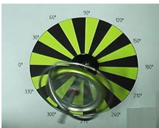
Figura 19: Vista superior do giroscópio filmado durante a precessão.
